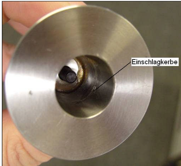
picture 5 damaged cone / beschädigter Konus
