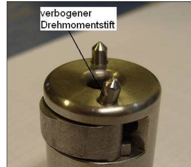
picture 6 damaged torque pin / beschädigter Mitnehmerstift
